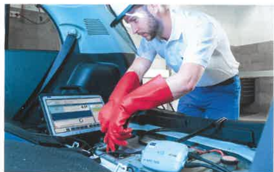
Das HV Safety 2000 ist speziell für Messungen im Hochvoltbereich ausgelegt.
